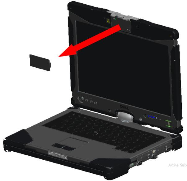
3. Insérez le dispositif module échangeable à chaud (caméra ou GPS). Assurez-vous que le dispositif est bien fixé.
