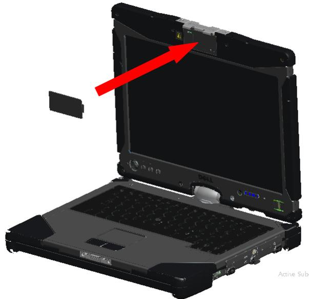
4. Verrouillez le dispositif module échangeable à chaud dans son emplacement en faisant coulisser le verrou jusqu'en position verrouillée.
